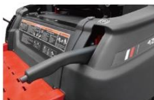
Handrem voor makkelijke bediening met één hand
