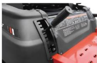
Hoogtinstelling 25 – 100 mm met 10 verschillende stand
