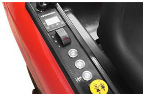
Bedieningspaneel (messenstop, achteruitmaaien, LED, cruise control)
