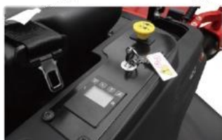
Gebruiksvriendelijk bedieningspaneel (LCD scherm toont werktijd, wielsnelheid, status veiligheidsschakelaars, krachtcapaciteit)
